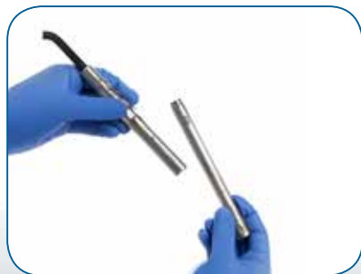
Elektroonilise mooduli ja aku eemaldamine enne autoklaavimist
