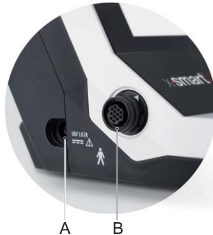
Joon. 4 Toide ja mootorpideme konnektorid
